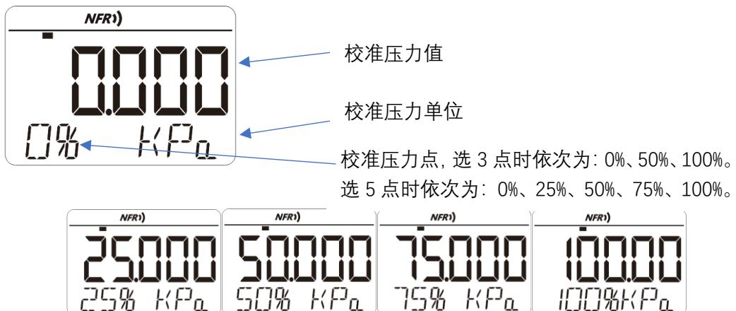
[校准压力值]闪烁时，表示还未采集数据，短按 M 键采集，采集成功后停止闪烁；
